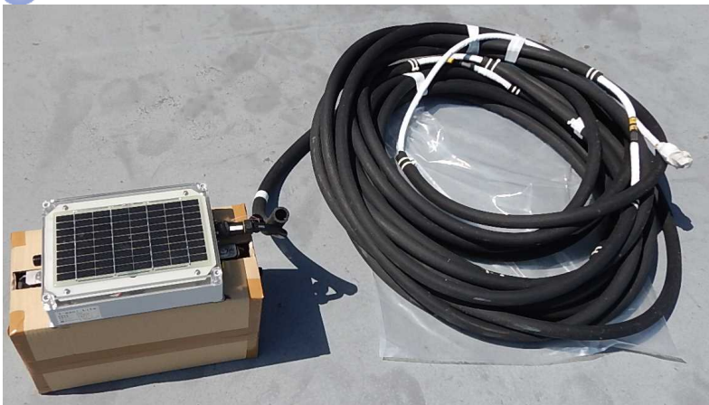
水温監視装置
